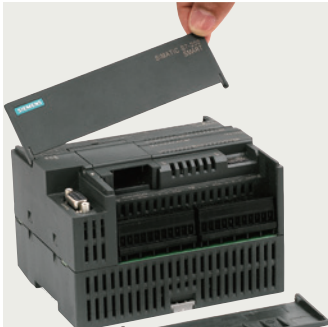
卸掉端子盖板
